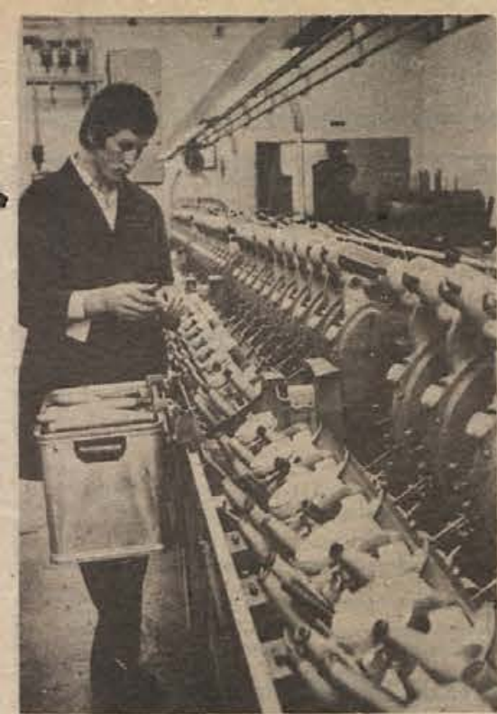
V metliškem obratu tovarne Novoteks imajo dva nova stroja. Enega vidimo na sliki. Ta avtomatsko čisti, navija in veže prejo. Stroj nadomešča najmanj 10 delavcev. (Foto: R. Bačer)
