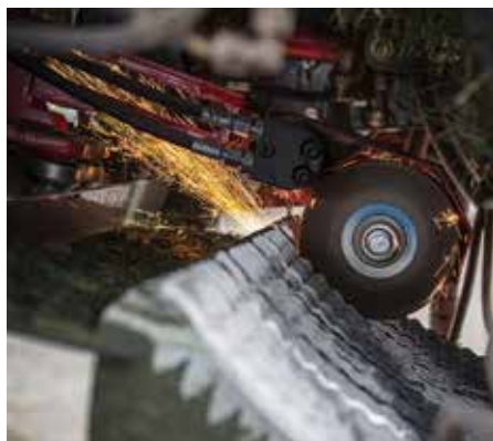
Vedno ostre nože, ki so osnova za kakovostno delo in manjšo porabo goriva, omogoča avtomatsko brušenje nožev. (vir slike: Pöttinger)
