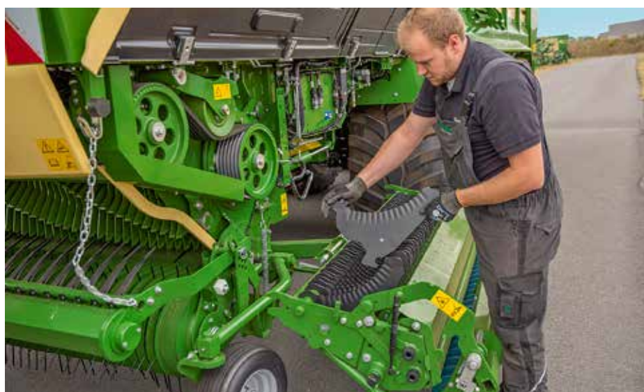
Možnost odmika rezalnega sklopa omogoča lažje vzdrževanje (menjavo nožev). (vir slike: Krone)
