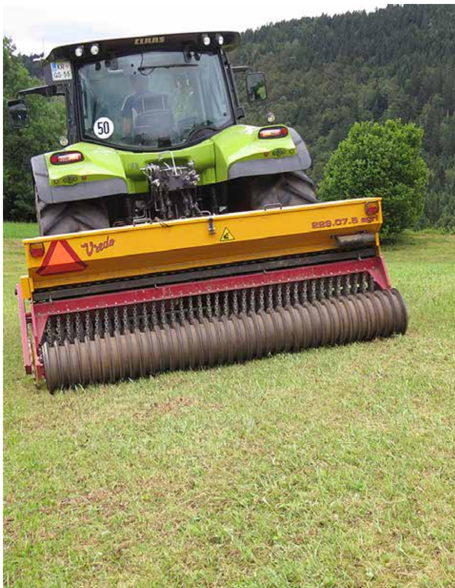
Tip sejalnice za vsejavanje v rušo takoj po opravljeni košnji.
