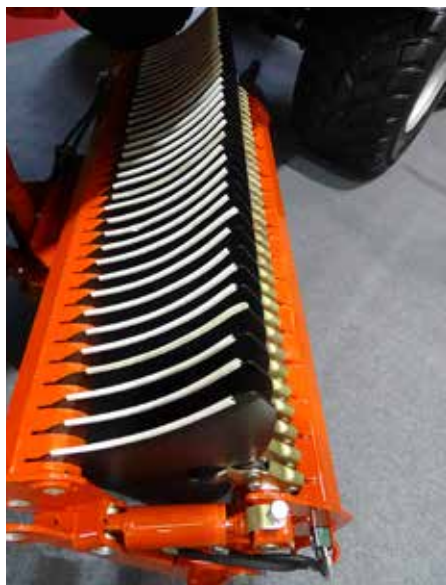
Pöttingerjev rezalni sklop POWERCUT ima 35 nožev, ki krmo režejo na dolžino 39 mm.
