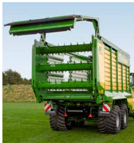
Razmetovalna naprava s tremi valji za razkladanje tovora. (vir slike: Krone)
