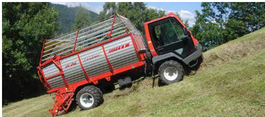
Na traktorje transporterje namestimo samonakladalno napravo, ki ima pobiralno napravo na zadnjem koncu.
