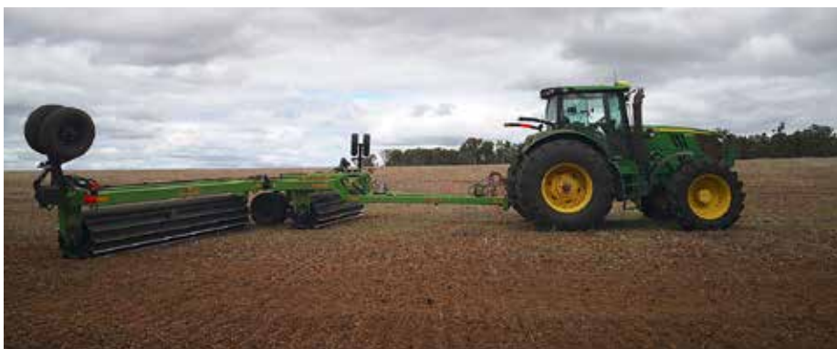
Na poljedelski kmetiji sem v času setve vozil valjar rastlinske odeje (roller crimpler) delovne širine 12 m.
