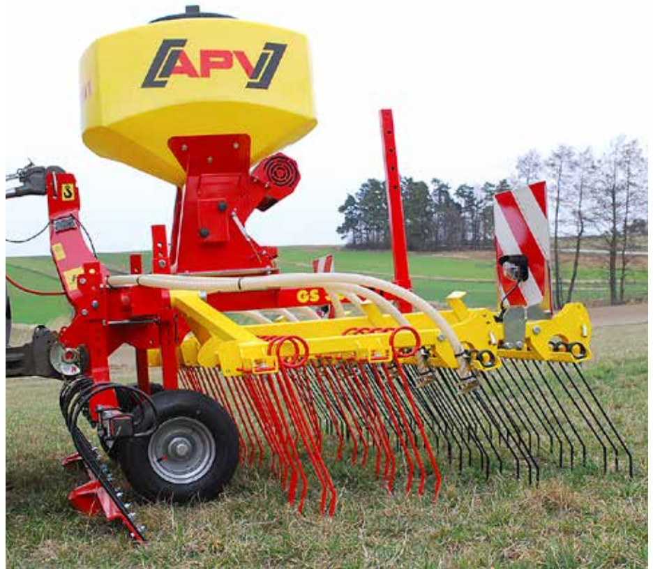
Pri sejalnicah za dosejavanje imajo pomembno vlogo žbice ali roglji, ki rušo odprejo.
