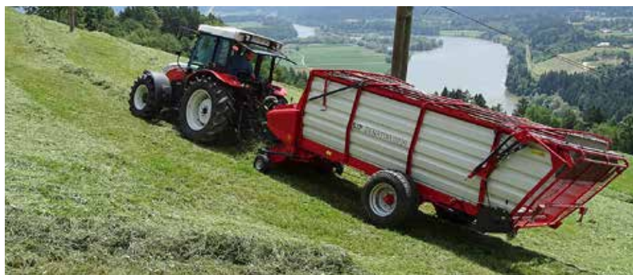
Nizkopodne izvedbe samonakladalnih prikolic s širokim kolotekom in tovorno ploščadjo med kolesi so primerne za delo na nagibu.
