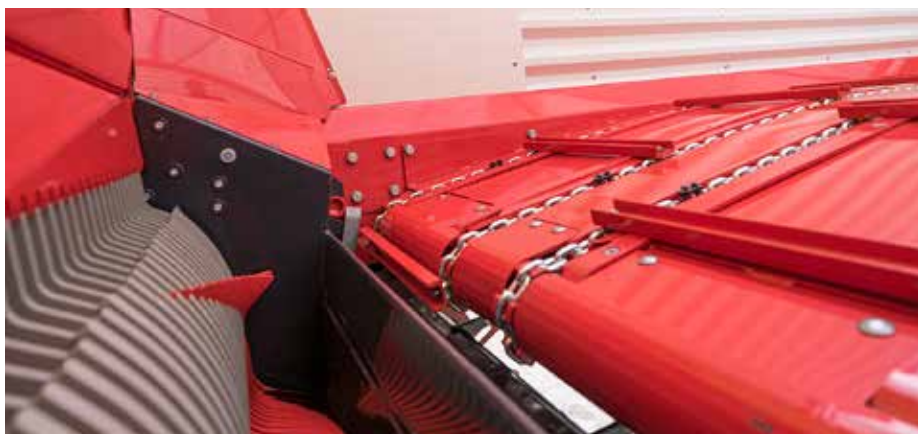
Poševno dno proti pehalu zmanjša potrebno moč za pogon in poveča tovorni prostor. (vir slike: Pöttinger)
