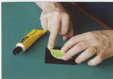
Slika 9. Lepljenje šablone iz mahgume na nosilec pečata
