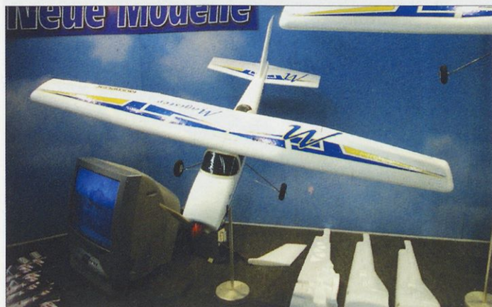
Magister je nov trenajni model z razpetino 163 cm, izdelan iz elapora. Za lažji transport mu snamemo krilo in višinski stabilizator, lahko pa ga opremimo tudi z motorjem z notranjim zgorevanjem (Multiplex).
