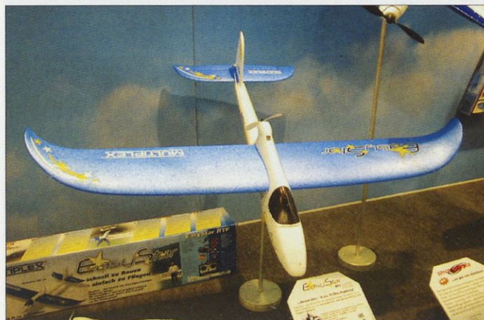
EasyStar ima pri razpetini 137 cm deljiva krila, v kompletu pa poleg vseh sestavnih delov modela dobimo še elektromotor Permax 400/6V (Multiplex).
