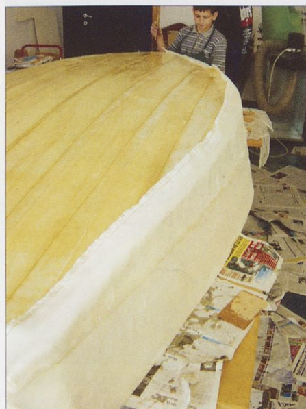
Slika 4. Skoparjenje s stekleno tkanino in poliestrsko smolo se tu ne izplača.
