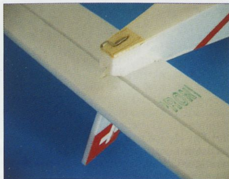
Pogon višinskega krmila je skrit v zadnjem delu trupa. Repna žična ostroga je s sekundnim lepilom vlepljena v ojačitev iz 3-mm balze.
