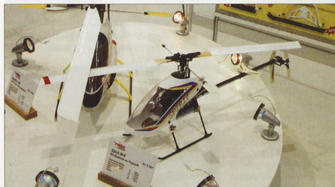
Manjši brat spirita L-16 je spirit M-8, ki ga ponujajo tudi v izvedbi pro. Helikopter s premerom rotorja 818 mm in vzletno maso 1300 g zmore tudi 3D akrobacije (Robbe).
