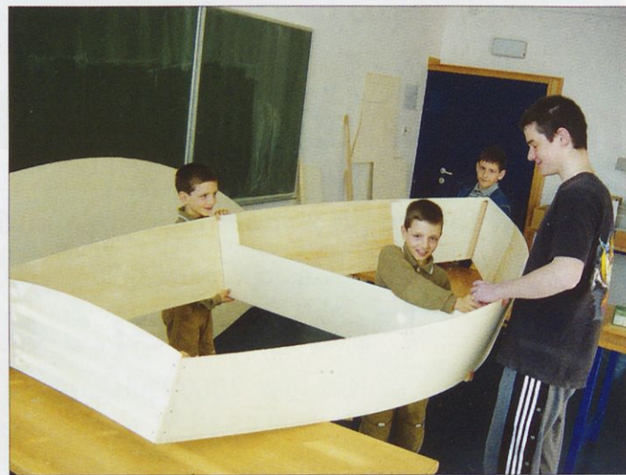
Slika 2. Sestavljanje bočnih stranic, glavnega in krmnega rebra
