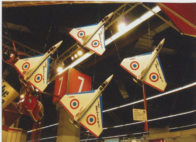
Za rekreativno šviganje po zraku si lahko omislite novi mirage, ki ga poganja potisni elektromotor razreda 400 (Robbe).
