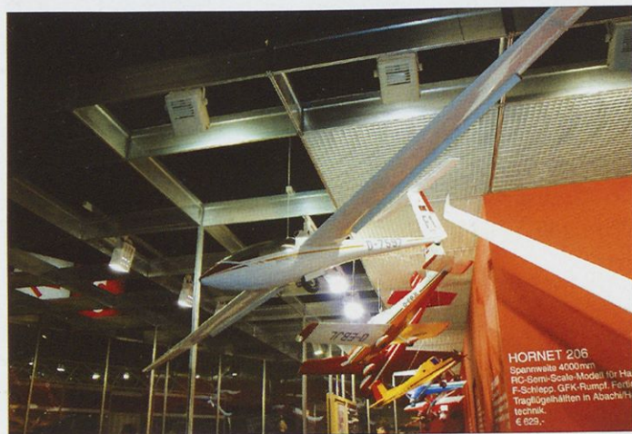
Štirimetrski maketa klasičnega jadralnega letala hornet 206. Posebej prevačunano krilo omogoča dobre letalne lastnosti za jadranje na pobočju in v termiki (Graupner).
