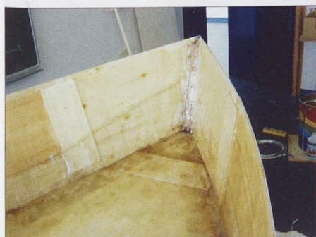
Slika 4. Skoparjenje s stekleno tkanino in poliestrsko smolo se tu ne izplača.
