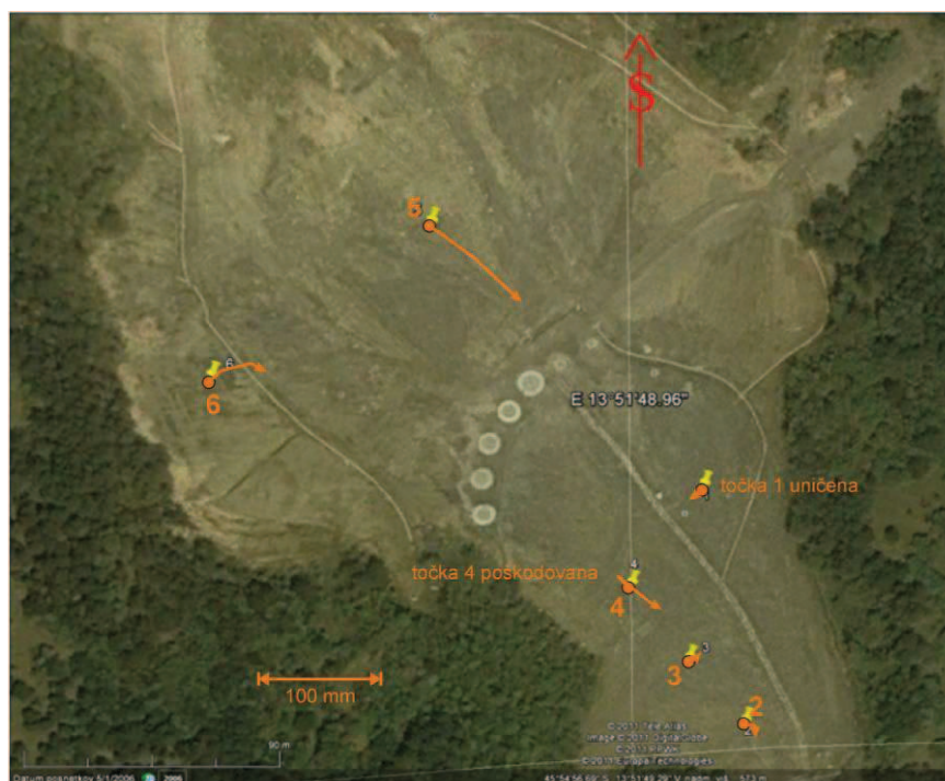
Slika 12.15: Lokacija geodetskih točk in pripadajoči pomiki točk.
