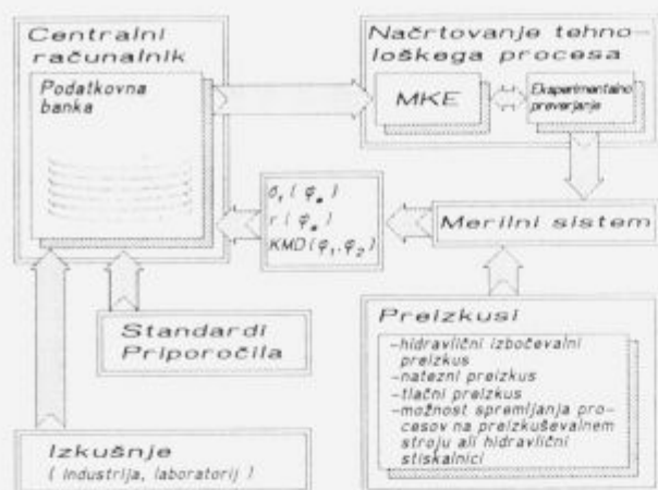
Slika 2. Organizacijska shema sistematičnega zbiranja podatkov o materialih in uporaba pri načrtovanju tehnološkega procesa. Figure 2. Organizing Scheme for Systematic Gathering of Material Data and Use in Process Planning.
