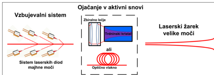
Slika 1. Shema diodno črpanega laserskega sistema velike moči
