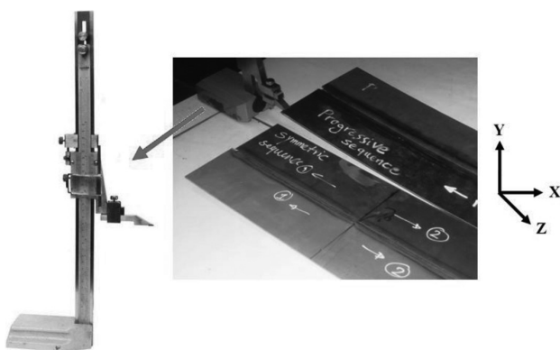
Figure 2: Measurement setup for the welding-induced distortion Slika 2: Merjenje popačenja oblike zaradi varjenja
