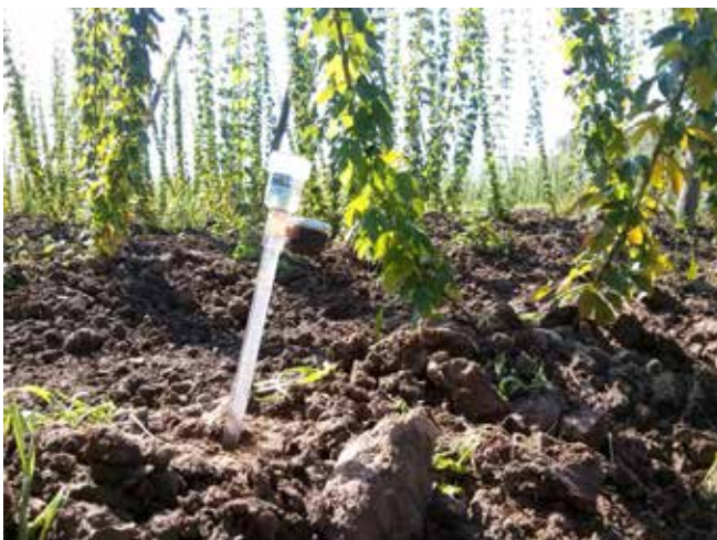
Tenziometri predstavljajo cenovno ugoden pripomoček za določanje sile vezave vode v tleh (foto: B. Naglič)
