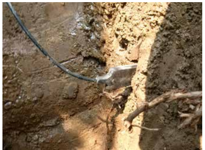
Različni elektronski senzori so zelo uporabni za določanje vlažnosti tal (foto: B. Naglič)
