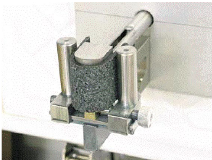
Slika 1 • Določevanje upogljivosti bitumenskih trakov pri nizkih temperaturah
