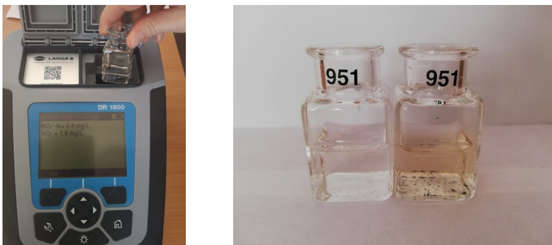
Slika 8: Izvajanje kontrolne meritve z uporabo spektrofotometra HACH DR1900 (levo) in pripravljena vzorca (desno)
