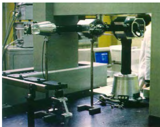
Kalibracija antropoidne merilne naprave v Laboratoriju za tehnološke meritve, Fakultete za strojništvo, Univerze v Mariboru (vir: Institut Jožef Stefan)
