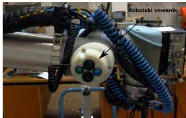
Slika 4 : Robotski vmesnik, ki omogoča vklop kinestetičnega učenja in zajem točk
