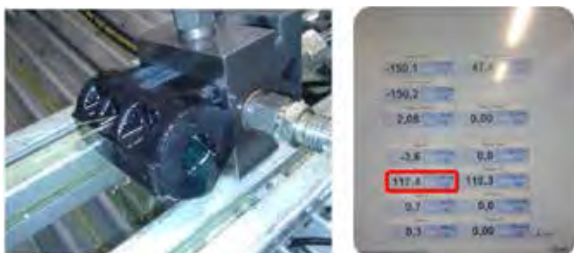
Slika 4 : Praktični preizkus karakteristik prototipa (tehnologija FDM)
