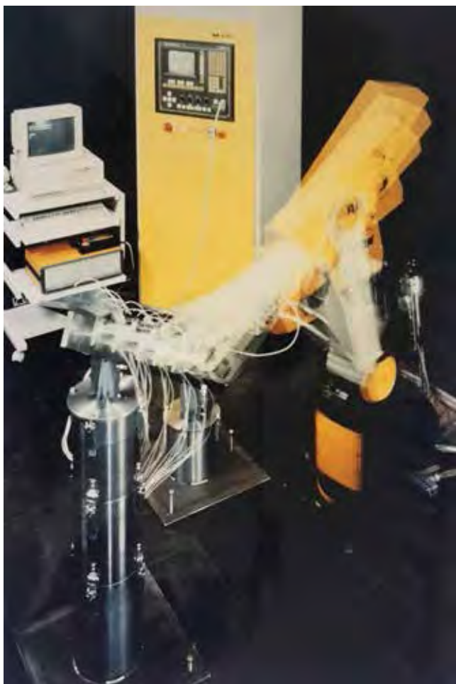
Merjenje industrijskega robota RIKO 106 na Institutu za proizvodno strojništvo, Tehniške Univerze v Gradcu, Avstrija (vir: Institut Jožef Stefan)
