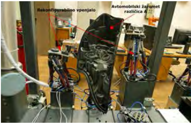
Slika 5 : Dva modela avtomobilskih luči, vpeta v rekonfigurabilno vpenjalo
