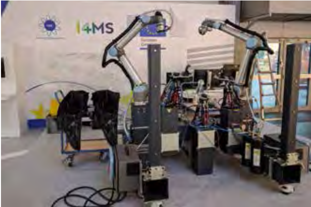
Slika 1 : Rekonfigurabilna robotska celica
