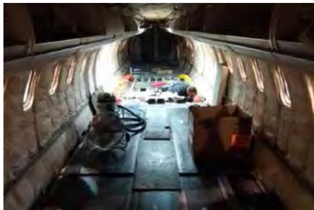
Slika 2 : Notranjost letala CRJ 700 – ojačitev strukture trupa letala nad
