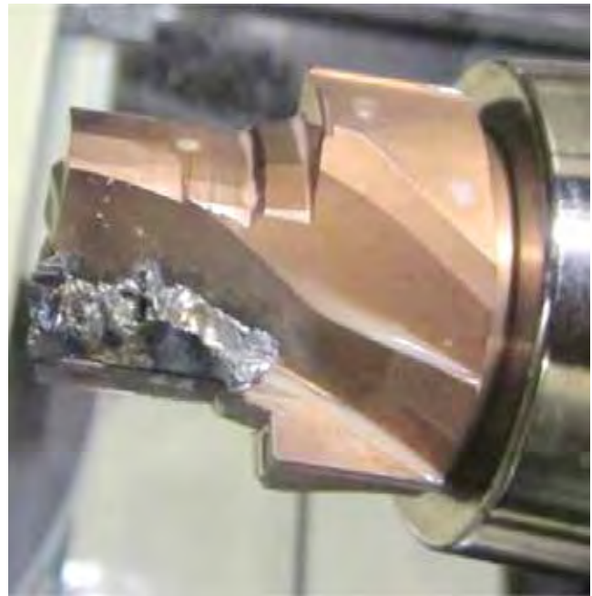
Slika 11 : Lepljenje odrezkov na rezilno orodje
