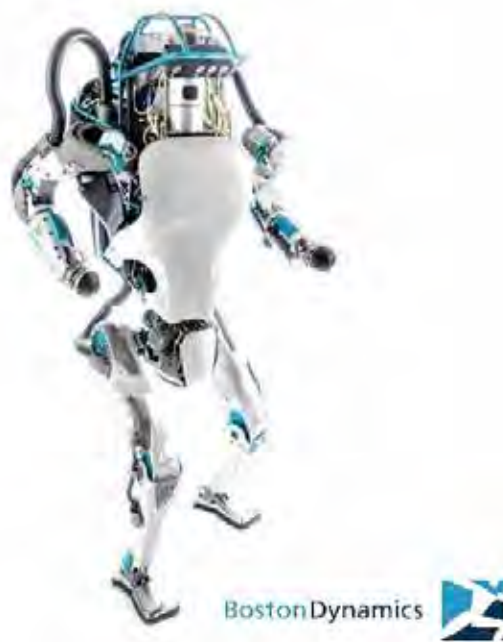
Slika 5 : Humanoidni robot na hidravlični pogon (vir: Boston Dynamics)
