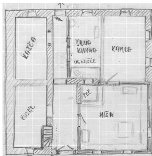
Slika 249: Kvadratna tlorisa kleti in nadstropja hiše na Hribce, osnovnih izmer 10,8x10,6m.
