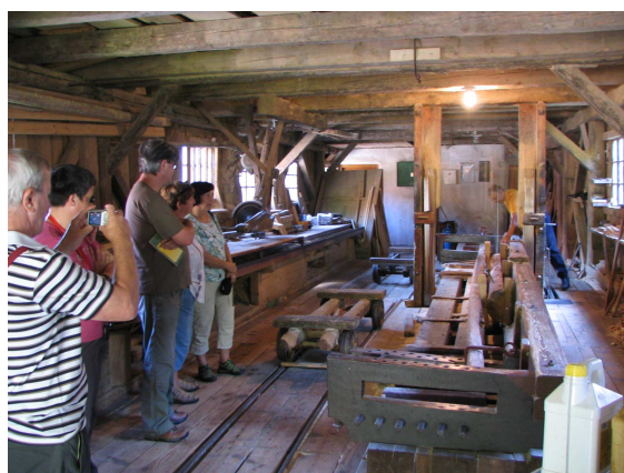
Slika 114: V notranjosti ohranjene Malinaričeve žage, Zamost. Oblikovanje stavbe je moralo slediti potrebam tehnologije.
