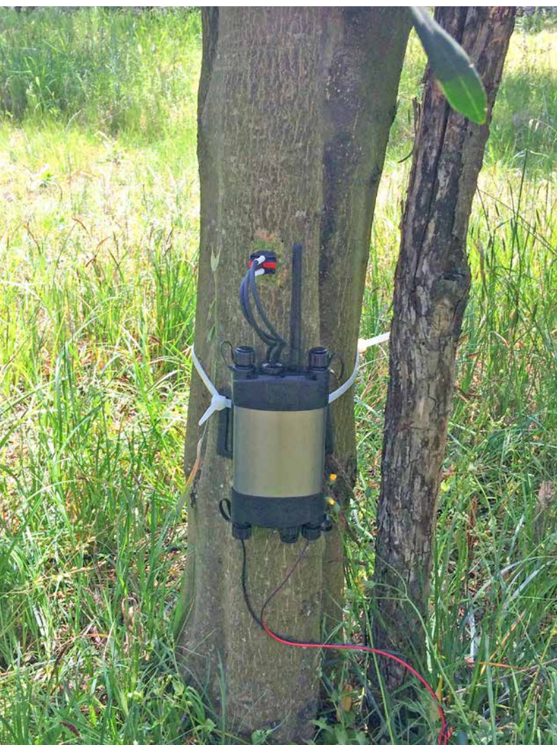
Slika 32: Načini spremljanja vode v rastlini z metodama SAP FLOW (levo) in TRUNK DIAMETER (premer debla) (desno).
