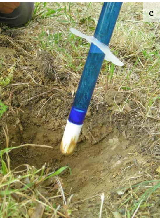
Slika 31: Metode in načini spremljanja vode v tleh z merilnikom TDR (a, b) in s tenziometrom (c).
