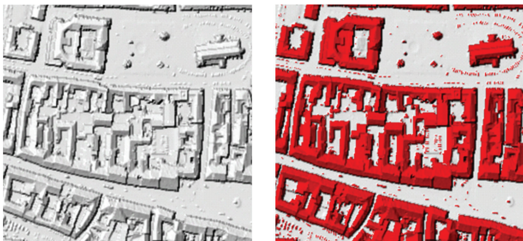
Slika 3: Prikaz površja z analitičnim senčenjem in samodejna zaznava objektov.
