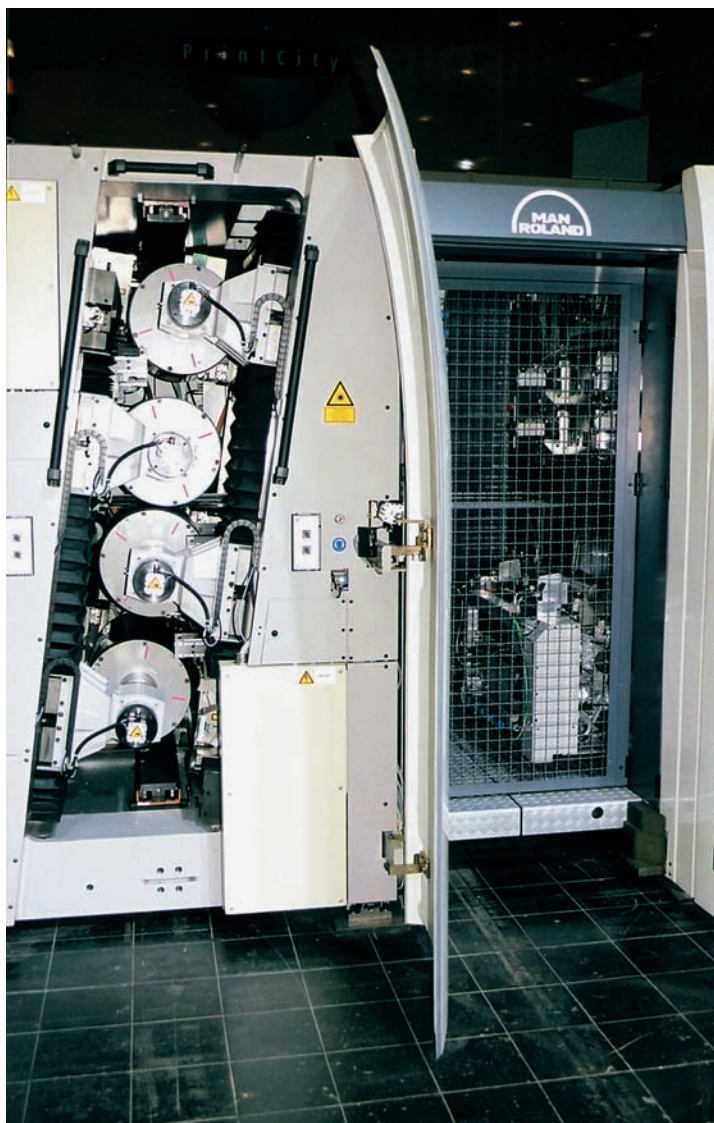
Tiskovni člen digitalizirane ofsetne rotacije MAN DicoWeb.
