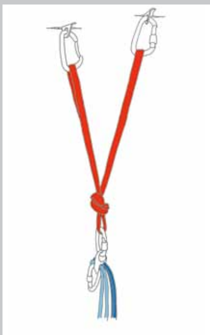
slika 1 - fiksno trikotno sidrišče
