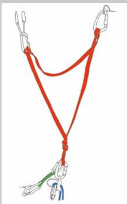
slika 2 - nastavljivo trikotno sidrišče
