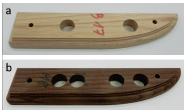
Slika 3. Preizkušavec za test rezkanja, a – nemodificirana bukovina, b – modificirana bukovina
