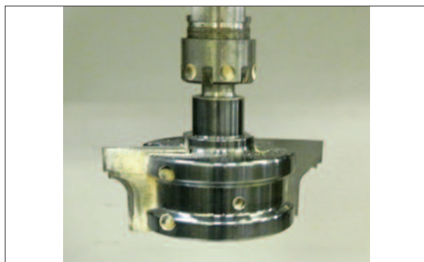
Slika 2. Rezkalna glava z 2 reziloma iz karbidne trdnine
