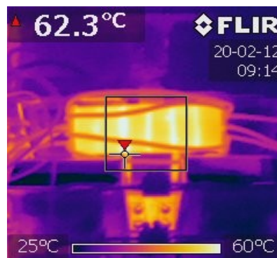
Slika 15: Pregrevanje toroidnih jeder sofazne dušilke
