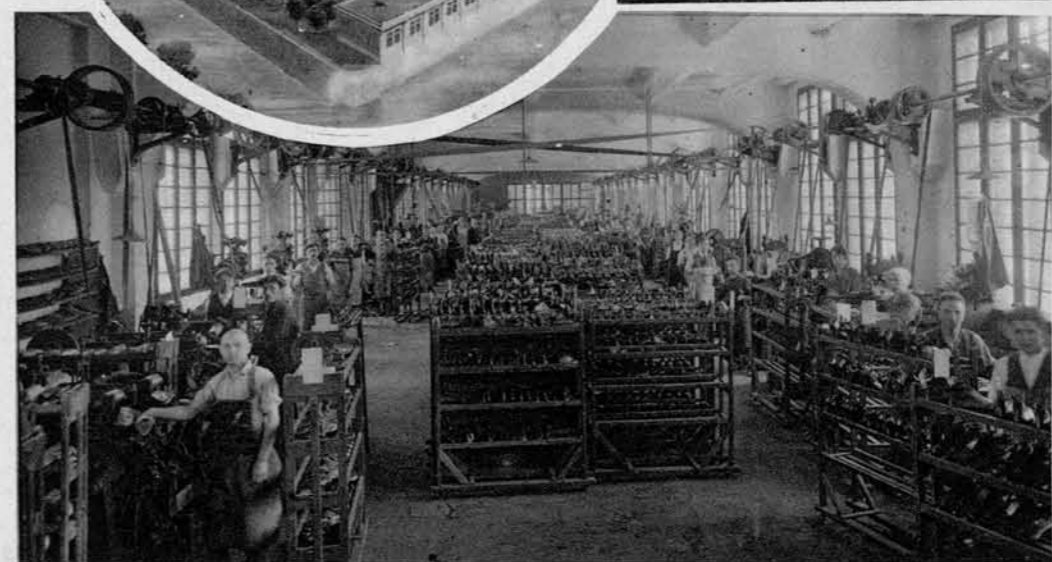
Napenjanje gornjih delov in nabijanje podplatov v tovarni čevljev v Ljubljani: Zgoraj v krogu: Pogled na tovarniške obrate v Kranju.
