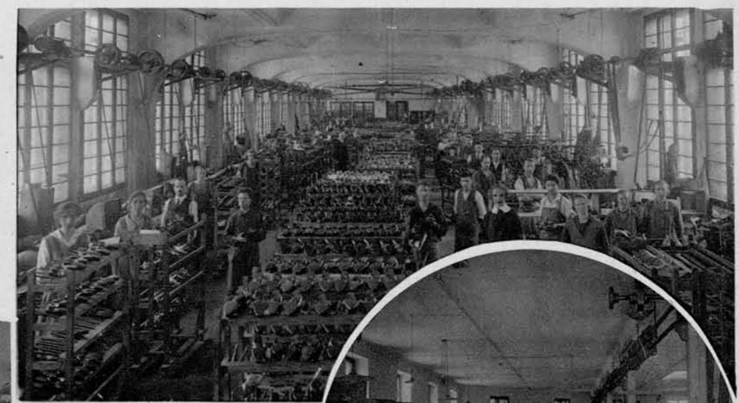
Napenjanje gornjih delov in nabijanje podplatov v tovarni čevljev v Ljubljani: Zgoraj v krogu: Pogled na tovarniške obrate v Kranju.
