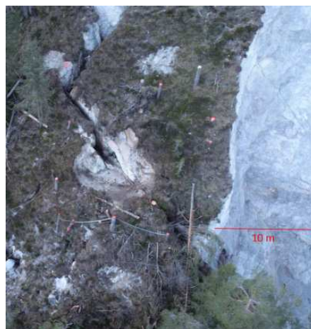
Slika 1 - vidne razpoke terena v zgornjem delu plazišča
