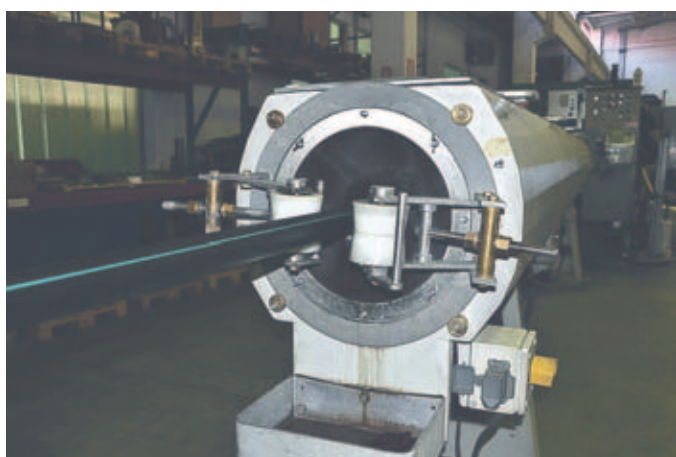
Novost v proizvodnji – stroj za izdelovanje nizkošumnih cevi iz polipilena
