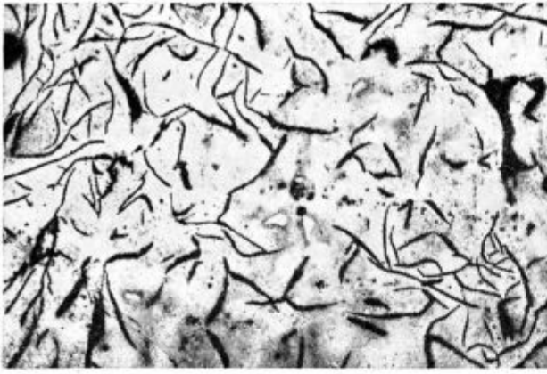
Slika 11 Struktura kokile grupe IV. Globina od notranje stene 3 mm. Povečava 100 ×, nital.
