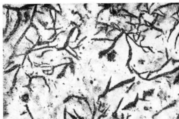
Slika 1 Struktura kokile grupe I. Globina od notranje stene 3 mm. Povečava 100 ×, nital.
