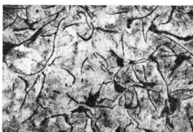
Slika 10 Struktura kokile grupe II. Globina od notranje stene 40 mm. Povečava 100 ×, nital.
