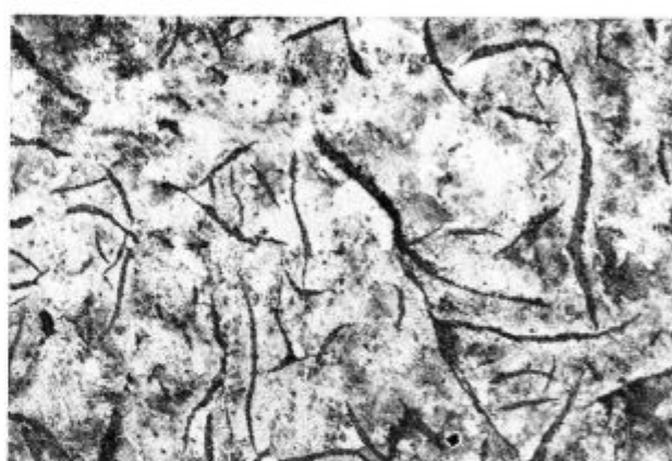
Slika 9 Struktura kokile grupe II. Globina od notranje stene 30 mm. Povečava 100 ×, nital.
