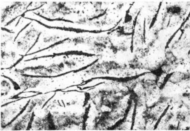
Slika 12 Struktura kokile grupe IV. Globina od notranje stene 10 mm. Povečava 100 ×, nital.
