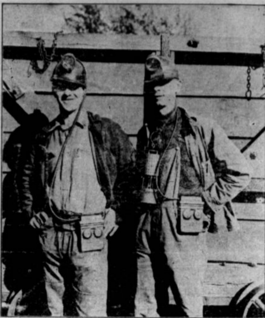
Prvotno so rudarji delali v rovih ob svitu sveč. Tem so sledile oljne svetilke, katere so izboljševali z različnimi izpopolnitvami. Koder ni bilo plinov, so rabili, ali rabijo karbidne svetilke. Philadelphia and Reading Coal and Iron kompanija pa je opremila svoje rudarje na antracitu z električnimi svetilkami. Na sliki sta rudarja, ki imata nove luči na kapi. Tok jima dovaja baterija, pritrjena na pasu. Rudar na desni na tej sliki ima še posebno svetilnico, katera jih opozarja na nevarnost plinov, češ električna svetilka ne more.
