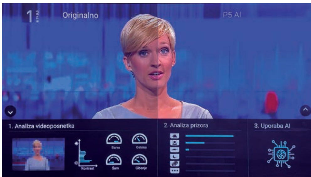
△ Vgrajeni slikovni procesorji danes počnejo marsikaj. Obvladajo tudi strojno učenje, s katerim prilagajajo sliko vsebini. Na sliki delovanje Philipsovega procesorja P5.
