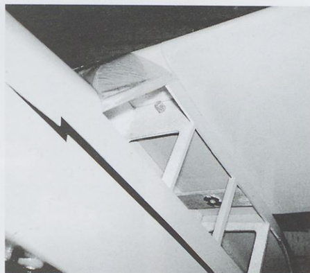
Slika 12. Lepo je vidna pritrnitev krila: spredaj bukov zatič, zadaj lesna matica za plastični vijak (zgoraj).
