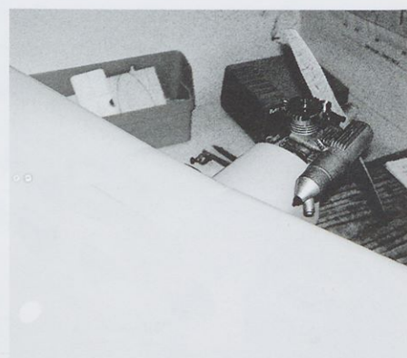
Slika 13. Plastični vijak se skriva v papirnati tulec, vlepjen v krilo. Na zadnjem robu krila ni stopnice, da nam ob morebitnem nerodnem pristanku ne odleti krilo in poškode trupa.
