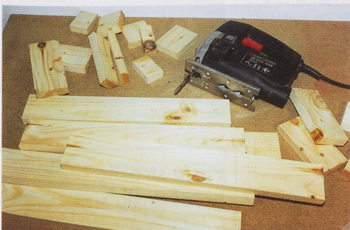
Slika 7. Pri žaganju sestavnih delov na ustrezno mero se izogibajte grčam, luknjam od žebljev in drugim poškodbam v lesu.
