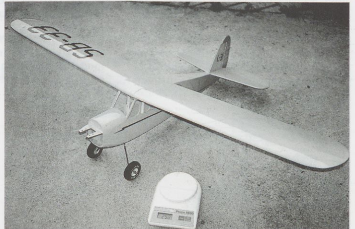
Slika 10. Prekrit in sestavljen model, nared za vgradnjo opreme tehta 298 g.
