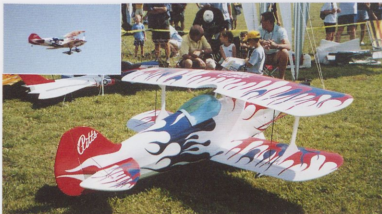
Claudio Boribello iz Italije je pripeljal model pitts special v merilu 1:2. Motor 150 cm 3 , razpon 2,65 m in masa 19,5 kg.
