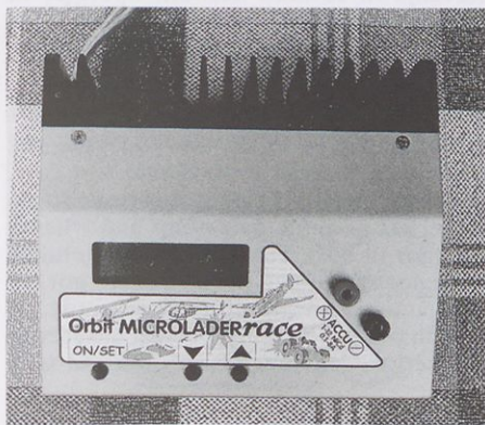
Slika 3. Posebnost polnilnikov Orbit je refleksno polnjenje, verzija microladerrace lahko polni od 1 do 12 celic s tokom od 0,1 do 8 A. (Foto: Miran Kos)
