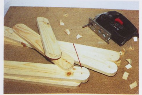
Slika 10. Polkrožno obžaganje letev z električno vpadno žago
