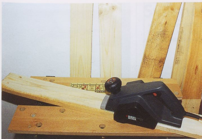
Sliki 5 in 6. Najprej poskobljajte obe ploski strani letev (levo), nato pa jih vpnite skupaj in poskobljajte še po robovih (desno).
