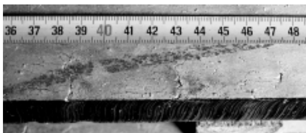
Slika 2: Prečne robne razpoke na plošči 3317, šarže 238182, vrste jekla X5CrNi18-10 – smer valjanja →
