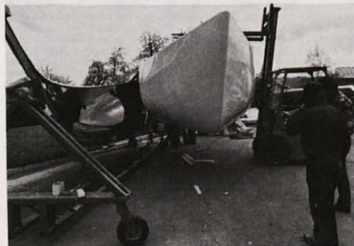
Izvlačenje jadrnice 707 iz kalupa
