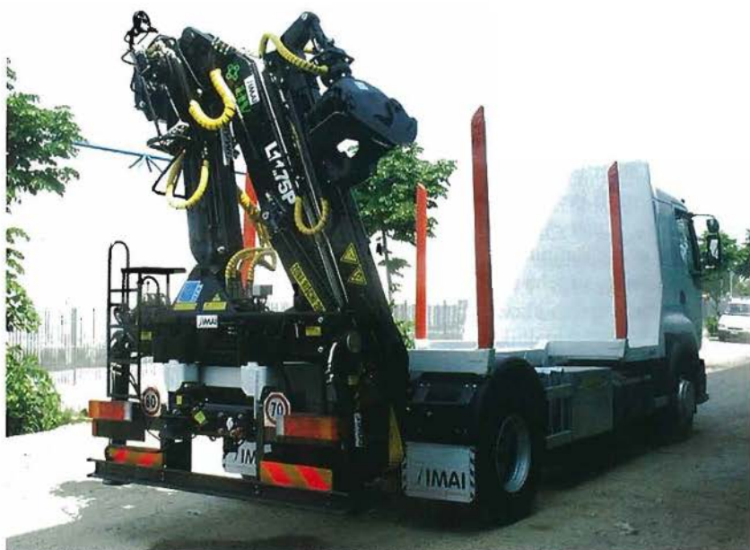
Hidravlični žerjav za gozdarstvo L 11.75P v zloženem stanju
