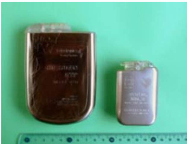
Sl. 13. Vsadni kardioverter defibrilator nekoč – dimenzije: 10,8 \times 7,6 \times 2,0 cm, teža 250 g (levo) in danes – dimenzije: 5,6 \times 7,1 \times 1,6 cm, teža 94 g (desno).
