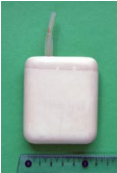
Sl. 1. Prvi srčni spodbujevalnik vstavljen v Ljubljani 16. 4. 1965. Dimenzije: 6,4 \times 7,2 \times 2 cm.
