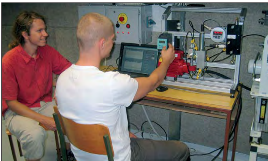
On-line sistem za nadzor stanja hidravlične tekočine z agregatom za ponazoritev mejnih stanj
