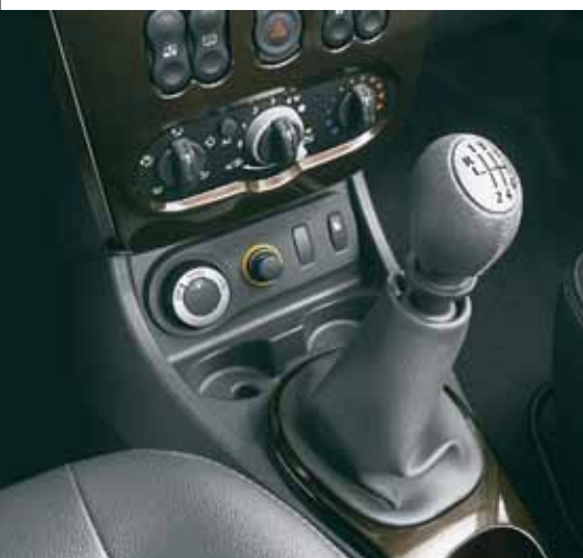
Delovanje štirikolesnega pogona dacie duster se uravnava z okroglim stikalom na dnu sredinske konzole.
