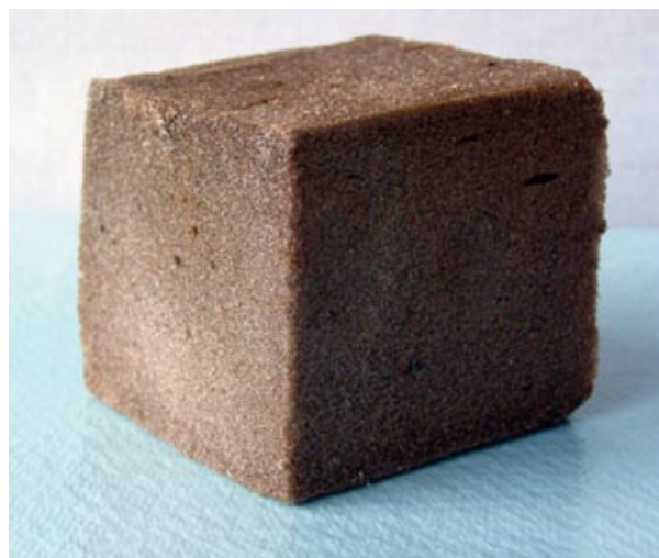
■ Slika 4: Poliuretanska pena, sintetizirana iz poliestra na osnovi utekočinjenega lesa
