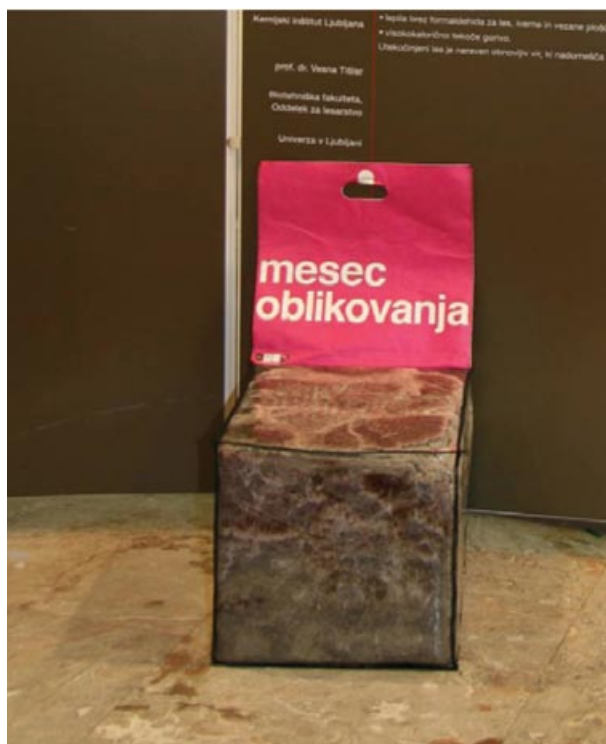
■ Slika 5: Stol SITintheSITy, izdelan iz poliuretanske pene na osnovi utekočinjenega lesa.
