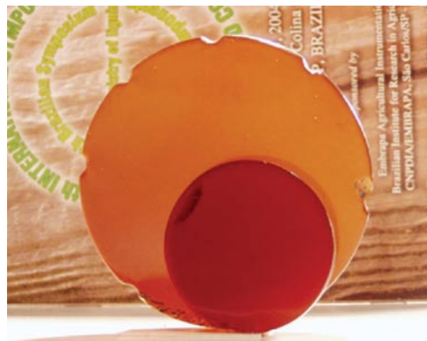
■ Slika 3: Zamrežen nenasičen poliestre iz utekočinjenega lesa
