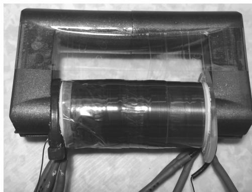
Slika 5: Fotografija za aplikacijo specifično zasnovanega transformatorja flyback
