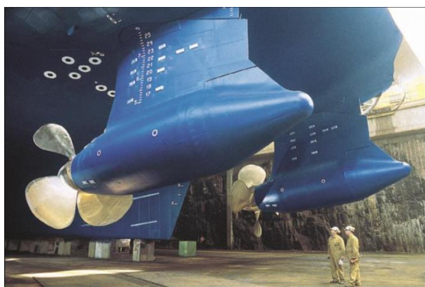
Slika 1: Vijaka modernega električnega pogona azipod
