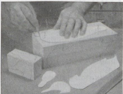
Slika 9. S pomočjo šablon iz kartona prenese-mo obris trupa in glave račke na dva ustrezno velika kosa lesa.
