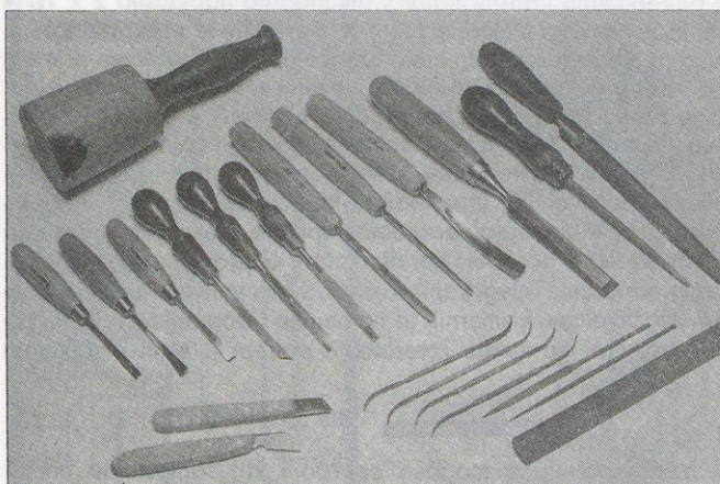
Slika 1. Rezbarjevo orodje: lesen bat, dleta, dolbila, žlebila, vrezila, noži, pile in rašpe.
