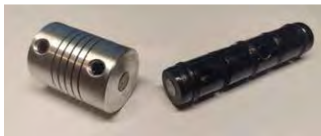
Slika 13 : Lom krmilnega bata na stiku z elastično sklopko
