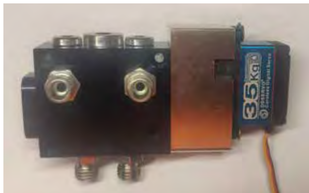
Slika 7 : Končni videz sestavljenega zasučnega ventila
