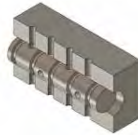
Slika 3 : Grobi model ventila z izdelanimi utori za tesnila na bat (54 mm x 29 mm x 27 mm)
