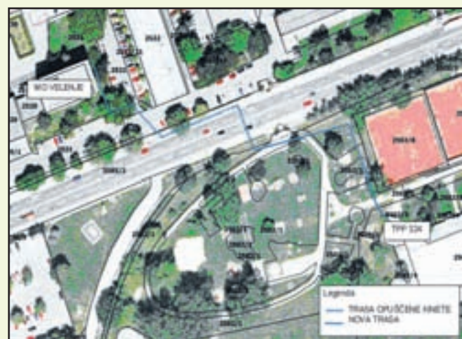
Glavni hladilni razvod dimenzije 2 x NO 100, temperaturnega režima 6/12 st C, bomo v 1. FAZI izvedli do objekta MO Velenje, v naslednjih fazah pa tudi do vseh ostalih poslovnih objektov n eposredno kolici.
