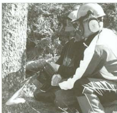
Inštruktorjev poduk o pravilnem zaseku
