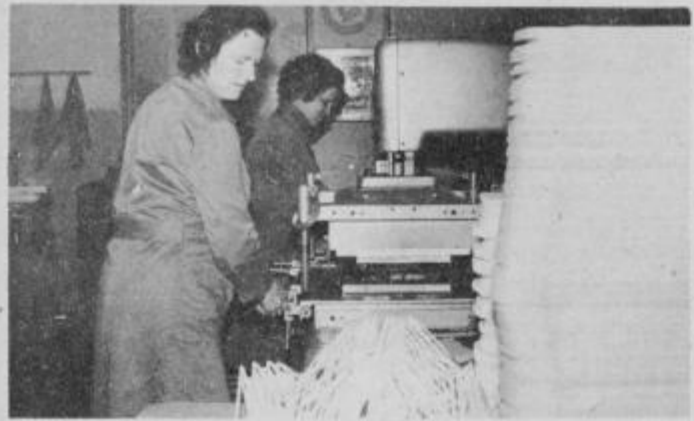
Na teh strojih teče visokofrekvenčno varjenje. Postopek je cenejši, hitrejši in delavke ga z lahkoto opravljajo.
