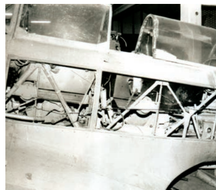
Sprednji in zadnji del kabine z vidno konstrukcijo rešetke trupa (Foto: Mitja Maruško)
