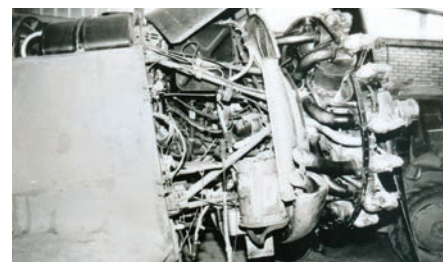
Bližnji posnetek devetvaljnega batnega motorja pratt & whitney R-1340-AN-1. Vidi se nosilec motorja, ki je bil pritrjen na požarno steno, in razmestitev ostalih delov motorja, ki je od konstruktorja Iva Šoštariča in njegovih sodelavcev zahtevala dobro poznavanje konstruiranja sodobnih letal. (Foto: Mitja Maruško)
