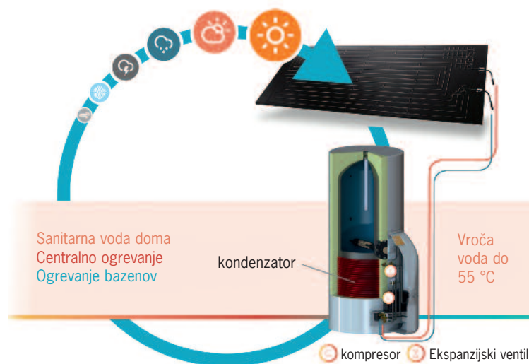
Prikaz delovanja termodinamičnega solarnega sistema
