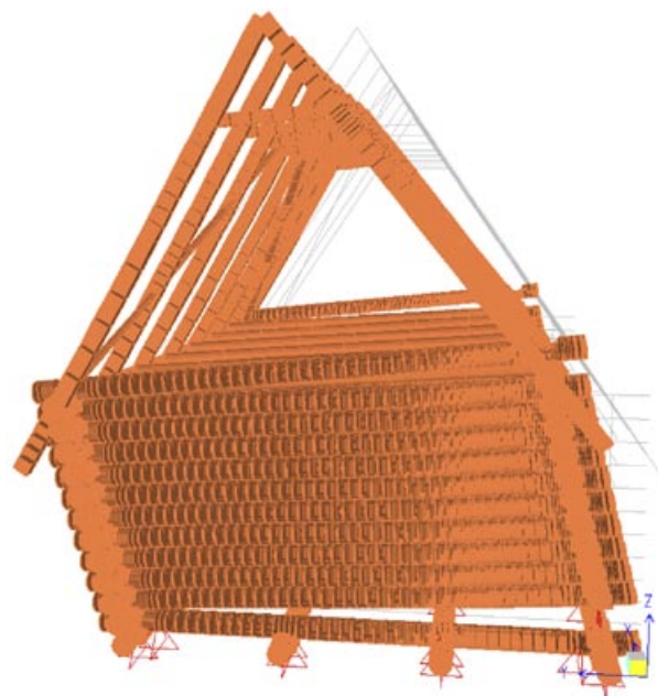
■ Slika 10. Deformirana lega konstrukcije na koncu pushover analize. Figure 10. Deformed shape of structure at the end of pushover analysis.
