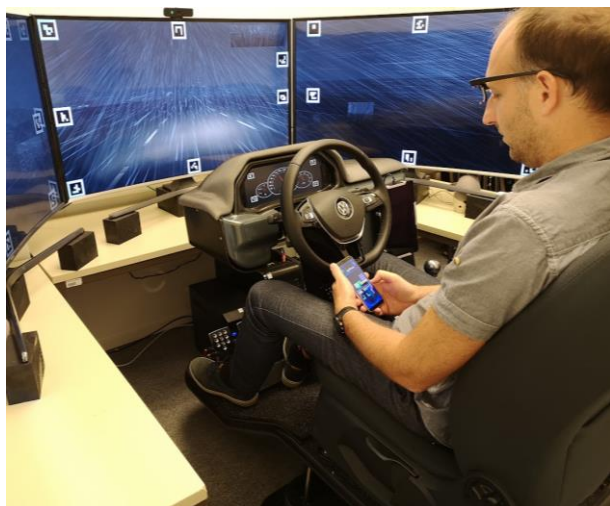
Slika 1. Nervtech™ simulator vožnje s 4-DOF premično platformo na Univerzi v Ljubljani, Fakulteti za elektrotehniko.
