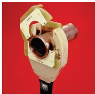
» Slika 4: Primer zaprte orbitalne glave [2]
