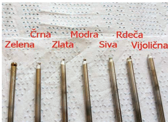
» Slika 5: Elektrode po drugem testu z izmeničnim varilnim tokom (zelena, črna, zlata, modra, siva, rdeča, vijolična)
