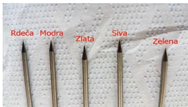
» Slika 1: Elektrode po ostrenju pred testiranjem (rdeča, modra, zlata, siva, zelena)
