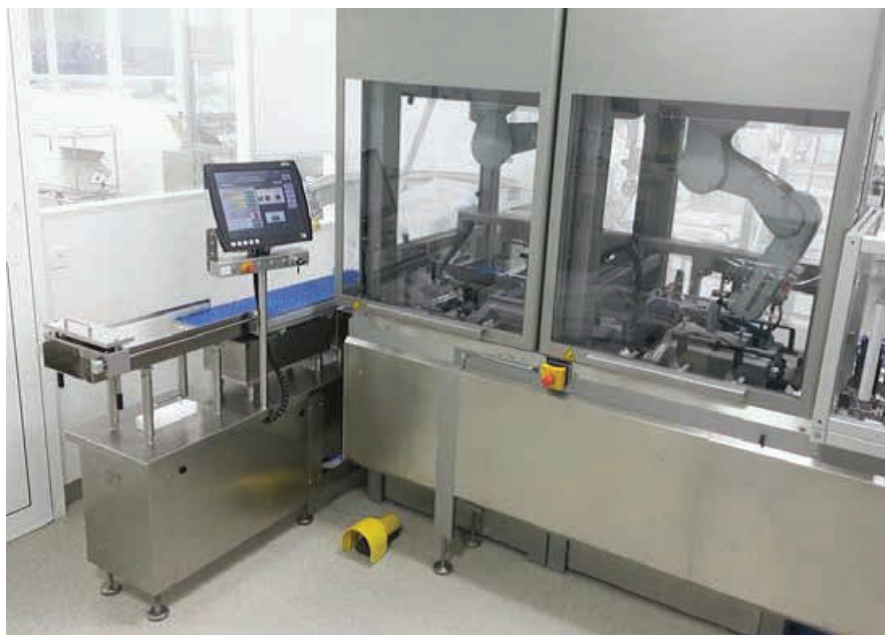
» Slika 5: Konkretna rešitev je sestavljena iz dveh MRT celic, z vgrajenima stropnima robotoma, ter transportnega traku gnanega s servo pogonom.
