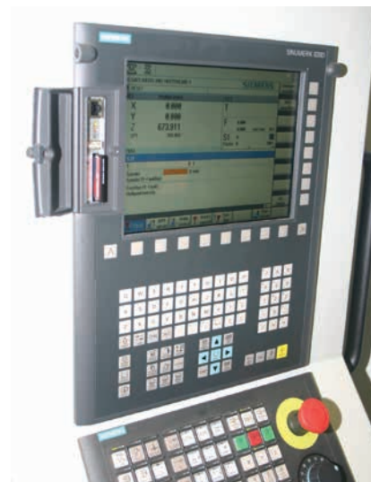
» Kompaktni CNC Sinumerik 828 D z uporabniškim vmesnikom Sinumerik Operate poenostavlja upravljanje novih obdelovalnih centrov Saeilo, ki pri Mayer Maschinenbau obratujeta od junija 2011.
