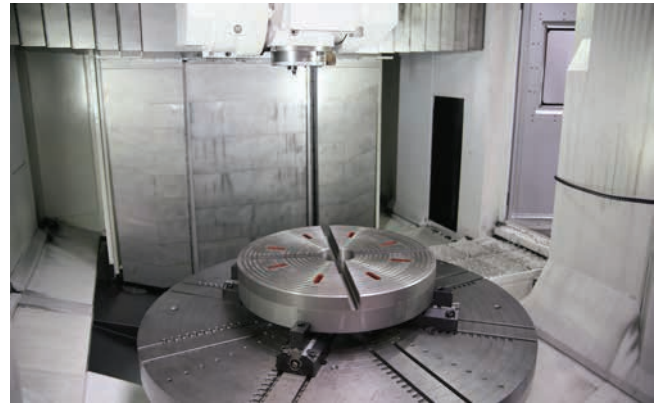
» Po zaslugi večopravilnega obdelovalnega centra VTM-2000YB, so v podjetju povečali ponudbo čelnih plošč za stružnice, saj sedaj lahko izdelajo čelne plošče tudi nad 1 250 mm v premeru.
