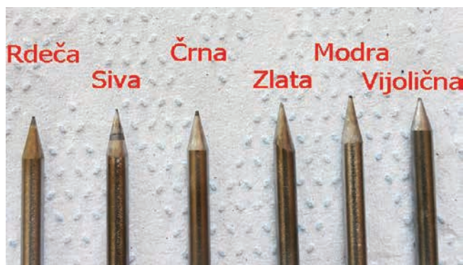
» Slika 3: Elektrode po testu 2 z enosmernim tokom (rdeča, siva, črna, zlata, modra, vijolična)
