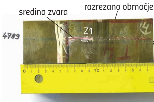
» Slika 8: Po razrezu z elektroerozijo.
