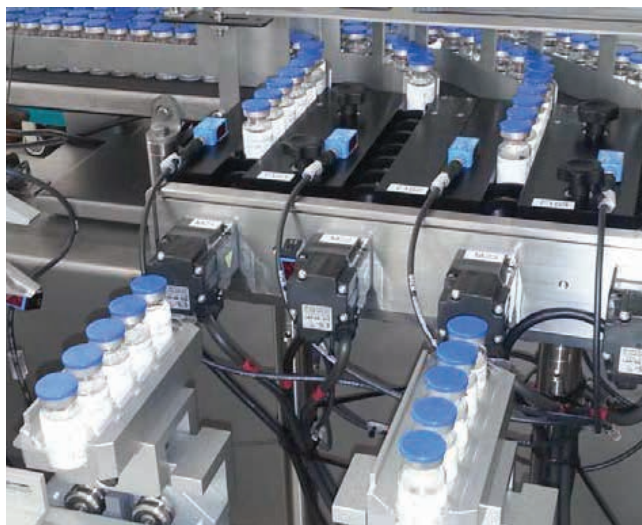
» Slika 2: Mitsubishijev MR-J4 servo pogon skrbi za gnanje pozicijskega vijaka, ki je namenjen zbiranju in pripravi stekleničk v skupine po pet.
