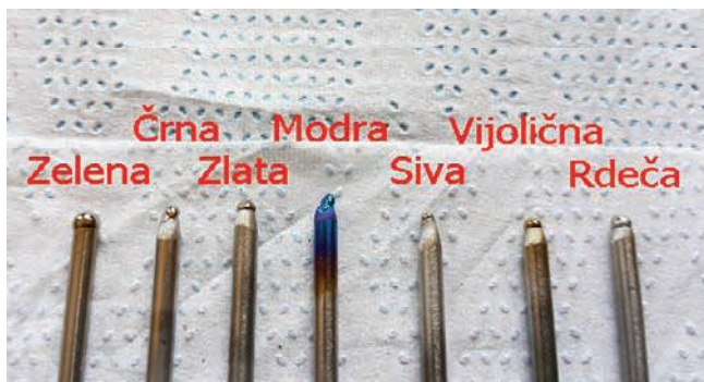
» Slika 4: Elektrode po testu 1 z izmeničnim tokom (zelena, črna, zlata, modra, siva, vijolična, rdeča)
