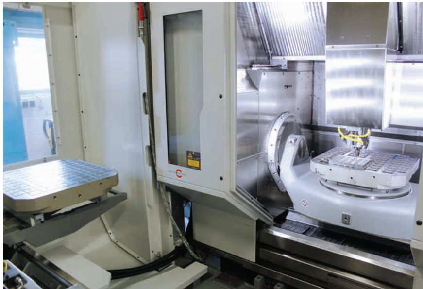
» Na sliki je prikazano veliko delovno območje obdelovalnega centra C 42 UP z 800 x 600 mm NC vrtljivo mizo, na katero se pritrdi obdelovalno paletno. Ena obdelovalna paleta je pripravljena za vpenjanje obdelovanca na levi.
