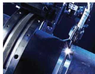
» Slika 6: Odprta varilna glava z vodili [1]
