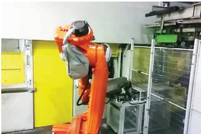
» Slika 9: Robot prijema neopeskano ročno gred iz vstopnega transporterja
