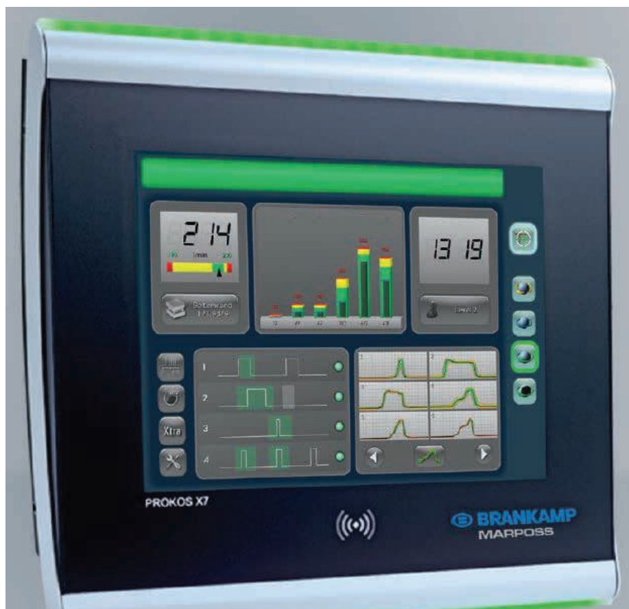
» Slika 2: Procesni nadzorni sistem BRANKAMP MARPOSS X7 za nadzor nevidnih mehanskih cikličnih procesnih parametrov sile, akustike, ultraemisije, z umetno inteligenco, s signali za ustavitev stroja v nekaj milisekundah po prekoračitvi meje procesa, deluje pri delovnih ciklih preko 1000/minuto, za 100 % kontrolo med procesom, s 24 analognimi vhodi-senzorji, 20 binarnimi vhodi/izhodi hkrati, z avtomatskim učnim postopkom nastavljanja mej procesov, avtomatskim diagnosticiranjem ... ( www.brankamp.com )
