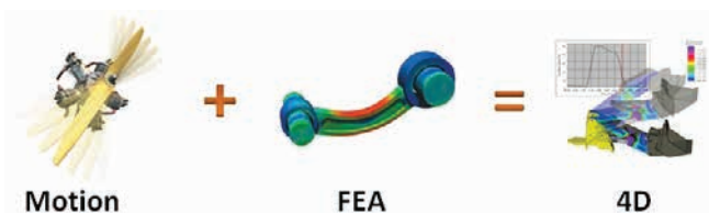
» Slika 1: SimWise4D združuje dinamične analize s FEA.
