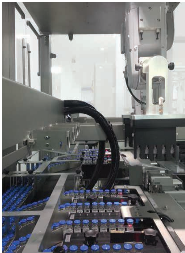
» Slika 4: Robot z vakuumskim prijemalom skrbi za dvig serije petih stekleničk iz vijakov za pozicioniranje in namestitvev za nadaljnje pakiranje.
