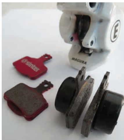
» Slika 1: Zavorna čeljust in zavorne ploščice. Na dveh sta nameščena zavorna batka iz čeljusti.
