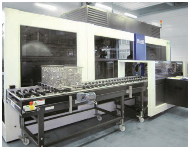
» Sodobni sistemi s topili omogočajo čiščenje in dolgotrajno konzerviranje sestavnih delov v enem sistemu in med enim postopkom.
