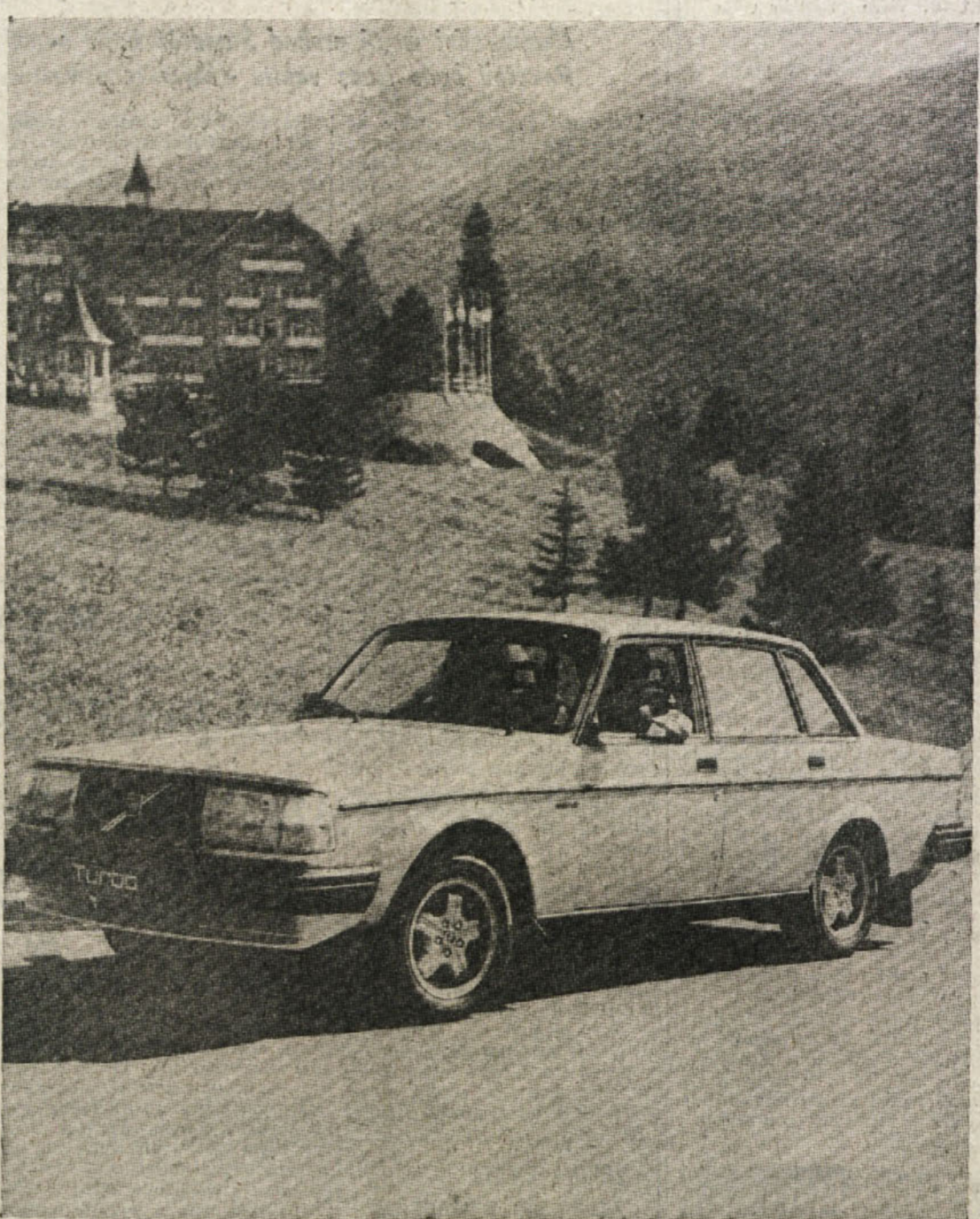
Tudi švedska tovarna Volvo je sklenila izdelati svoj «turbo»: model 244 bo v izvedbi «turbo» zmogel 155 KM pri 5500 obratih v minuti in najvišjo hitrost 190 km na uro; stal bo revnih 18 milijonov lir
