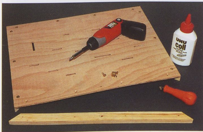
Slika 6. Sestavljanje okvirja z lepilom in lesnimi vijaki; luknje za vijake je treba nekoliko povrtati, da se njihove glave skrivajo.
