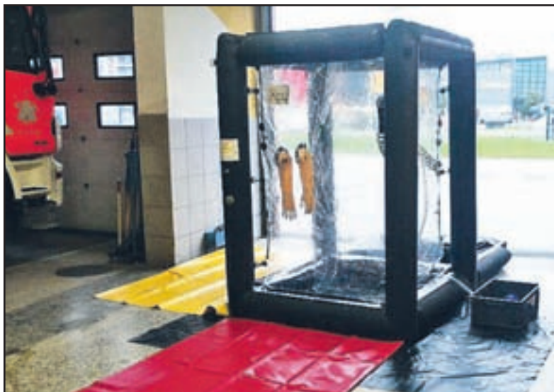
Dekontaminacijska enota je samonapihljiva, narejena iz negorljivih, trpežnih materialov in jo lahko postavi le ena oseba. Gasilci iz MO Velenje jo bodo uporabljali ob izpostavljenosti nevarnim snovem.
