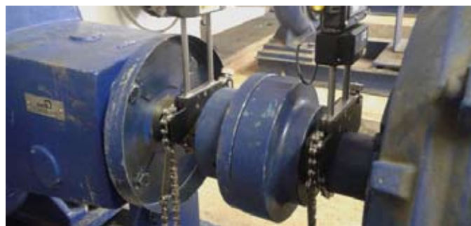
Slika 1: Centriranje KSB črpalke poz. 02.61
