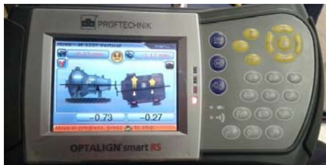
Slika 2: Potreben vertikalni pomik pomičnega stroja
