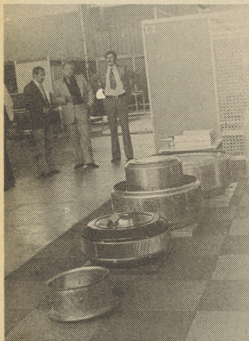
Trije osnovni tipi strešnik ventilatorjev (od zgoraj navzdol): SRV, SRV-P in SRH
