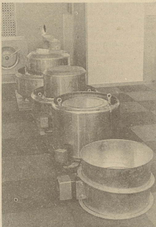
Skupina SRV-P ventilatorjev različnih velikosti. Spredaj dušilna loputa z motornim pogonom
