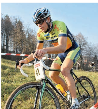
Luka na posebnem kolesu za ciklokros, ki je podoben specialki, razlikuje se po geometriji okvirja, obročni so obuti v »krampaste« in malo širše plašče, zavore so cantilever, predhodnice »modernejših« V-zavor.
